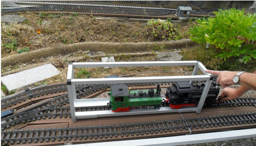
Am Tag Zwei, wurden in die 720mm langen Vierkantrohre symmetrisch mit Bohrungen, für die beiden Niederhalter, aus den 180mm langen Rechteckrohren, M4 Schrauben und den Dämmplattendübselscheiben, ein gebracht.
