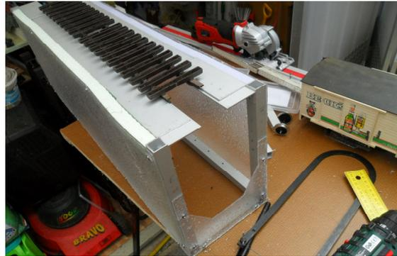
Die beiden Platten an den Stirnseiten haben zusätzlich die Aufgabe, das auseinander Triften der Bodenwinkel zu minimieren.
