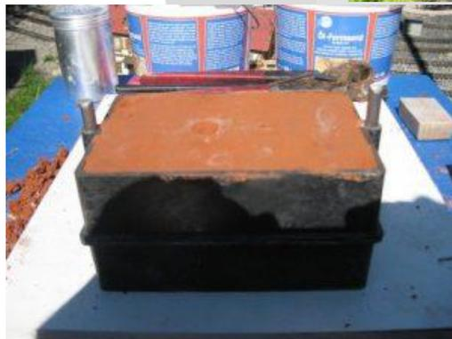
platzieren. Anschließend den oberen Formkasten aufsetzen und ebenfalls mit Formsand füllen/verdichten. Einguss Öffnung und Entlüftungsöffnung mit Hilfe eines Messingröhrchens einstecken. Nun die obere Formhälfte abheben und
