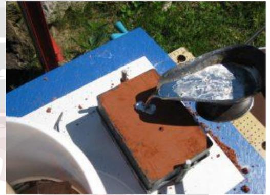
Urform entnehmen. Das innere der Form Formhälften wieder zusammenbauen. Das fixieren nicht vergessen! Nun das Blei (eventuell unter Zugabe von Zinn / verbessert die Fließfähigkeit) erhitzen und anschließend in die Form einlaufen lassen. Nach kurzer Wartezeit kann die Form getrennt und das fertige Bleigewicht entnommen werden. Beim Erhitzen von Blei die einschlägigen Sicherheitsvorschriften einhalten und vorzugsweise im Freien arbeiten. Also immer gute Fahrt! Lg Reiner...
