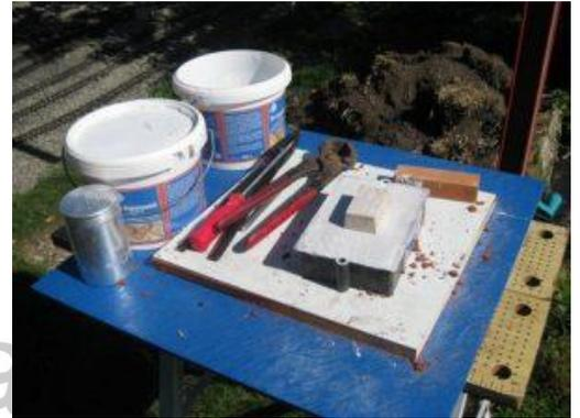
und Brenner, Topf oder ähnliches, Schmiedezeange zum entformen und hantieren, diverse Spatel und Röhrchen. Als erstes das Unterteil des Formkastens mit Formsand füllen und verdichten, die Oberfläche mit Talkum bestäuben und die Urform
